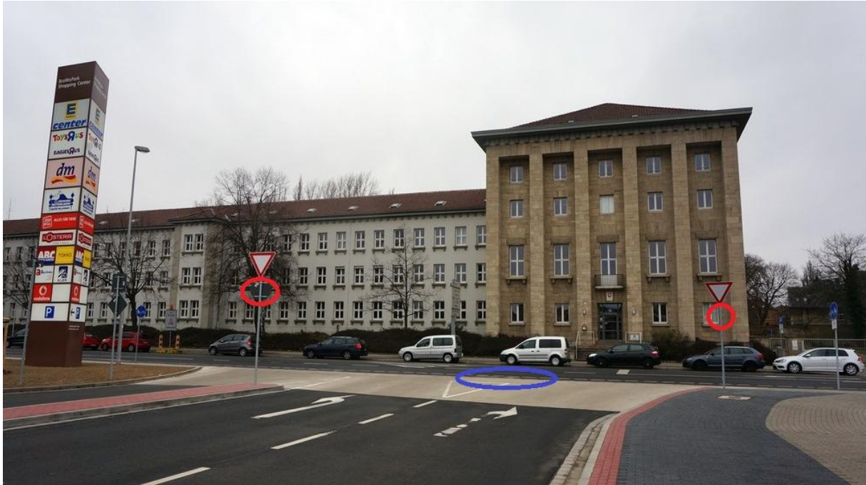
Bild 2: Zufahrt von / auf die Schillstraße - kleines Fahrradsymbol (blau) ist für Autofahrer nicht sichtbar – Vorschlag: zusätzlich großes Fahrradsymbol (blau) mit zwei Richtungspfeilen ins Gelände hinein verlegen und/oder Zusatzschilder (rot) unter „Vorfahrt gewähren“ mit Hinweis auf querenden Radverkehr aus beiden Richtungen
