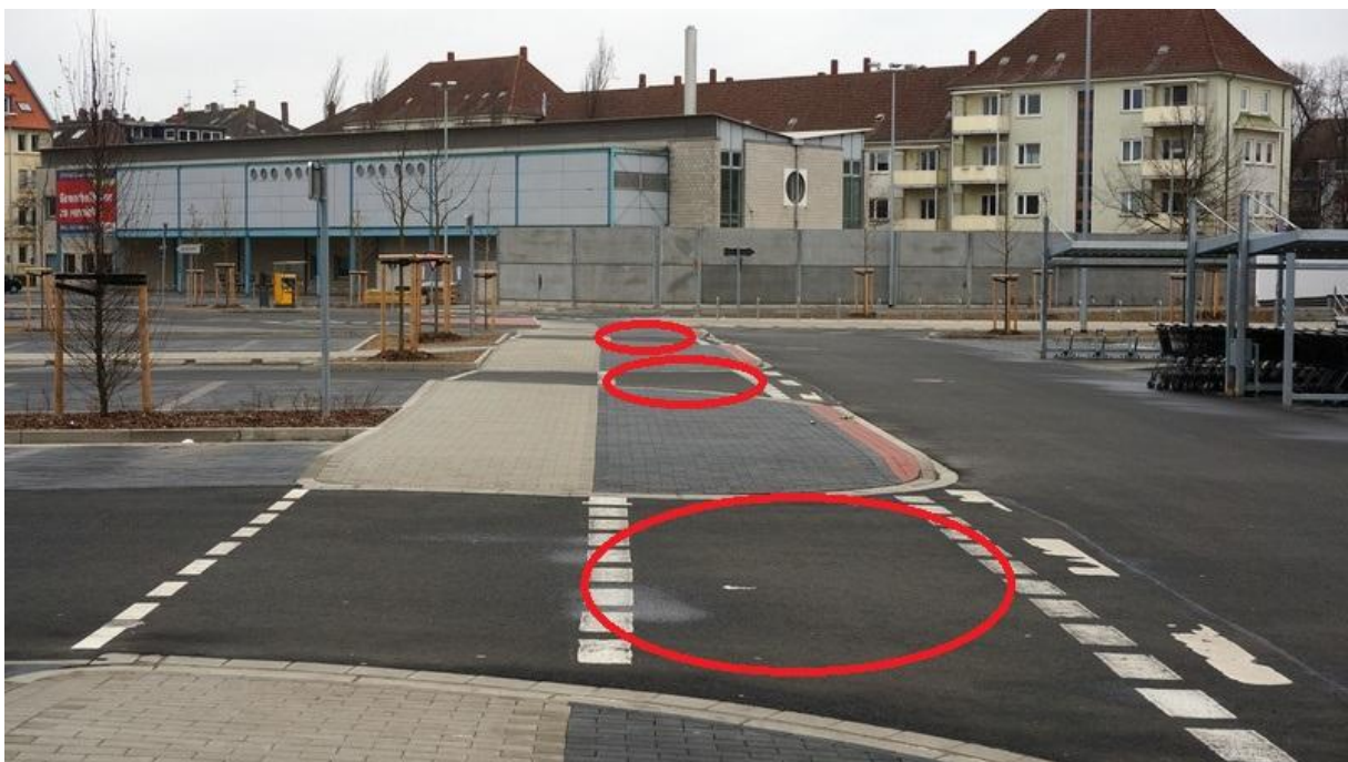
Bild 3: Radwegfurten auf dem Parkplatzgelände - Vorschlag: große Fahrradsymbole mit zwei Richtungspfeilen
