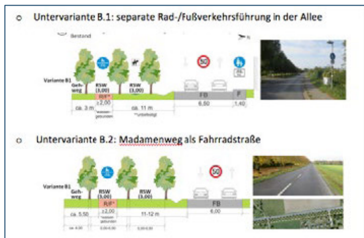
Abbildung 7: Mögliche Führungsformen Radschnellverbindungen am Beispiel Madamenweg
