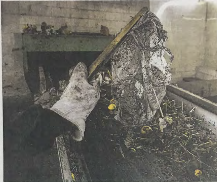
Zu viel Plastik im Biomüll: Ein Mitarbeiter sortiert in der Vergärungsanlage des Biomassezentrums von Alba Fremdstoffe aus der Biomasse. Alle kann er nicht erfassen.
