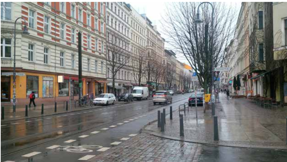
Beispiel für die Trennung von Abspannmasten für die Stadtbahn und Beleuchtung (Beispiel Berlin), dadurch kann eine angemessene Lichtpunkthöhe für Fußgänger gewählt werden.
