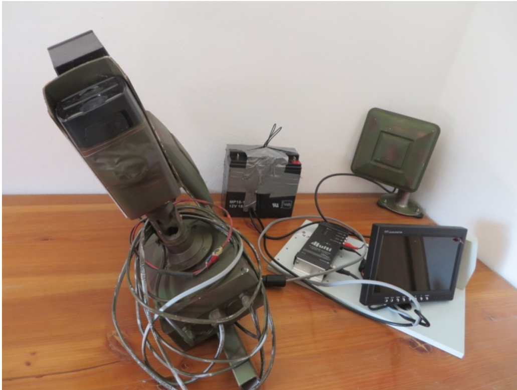
Abb. 22: IR-Funkkamera, Batterie, Empfänger und Monitor mit Steuerteil
