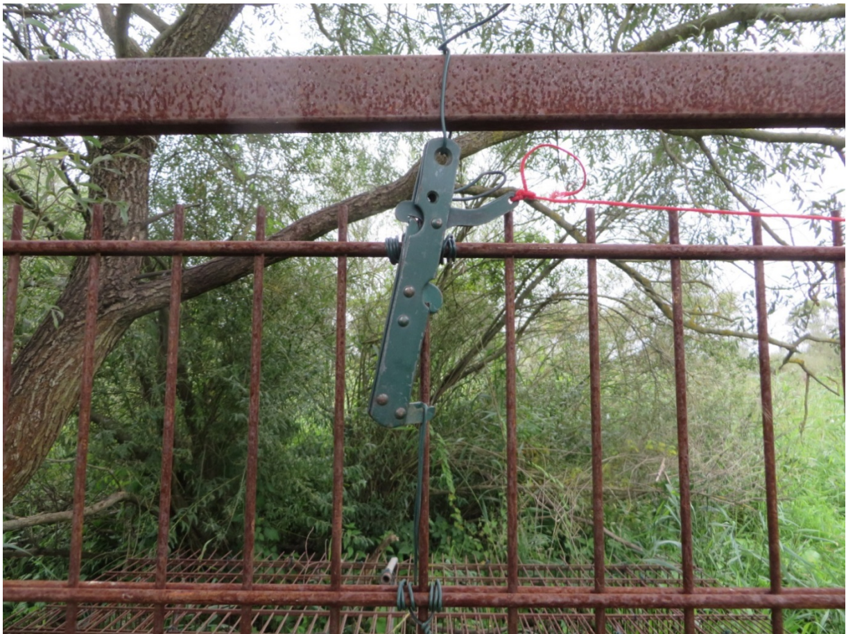
Abb. 3: Auslösemechanismus und Zugleine zur Auslösung
