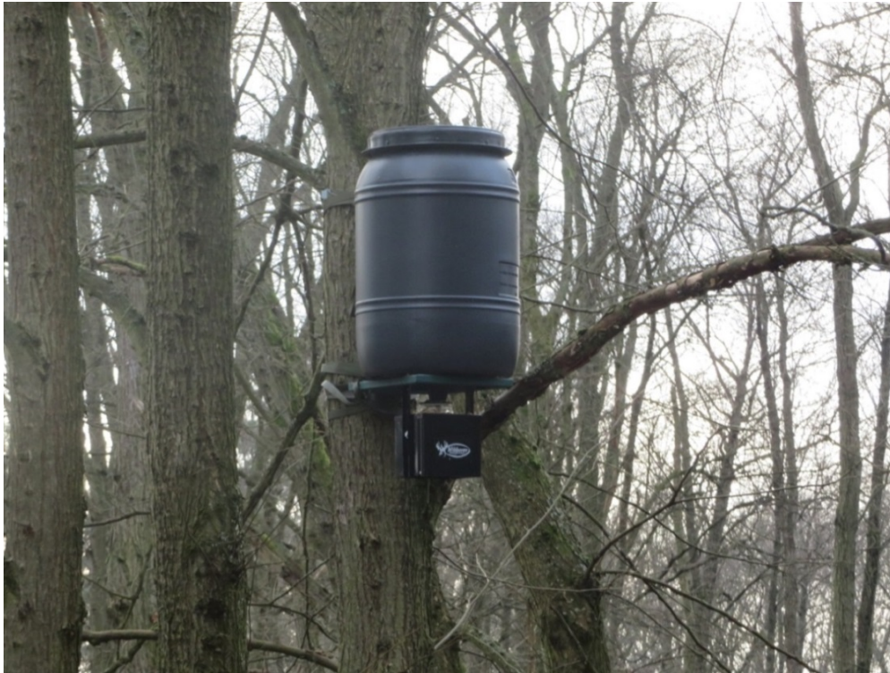
Abb. 19: Zur sparsamen und störungsarmen Versorgung der Fanganlage mit Lockfutter ist ein Futterautomat (genehmigungspflichtig) mit elektronischer Zeit- und Mengensteuerung empfehlenswert, eine manuelle Beschickung ist ebenso praktikabel
