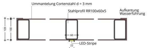
Konstruktionsdetail Dach M 1:5
