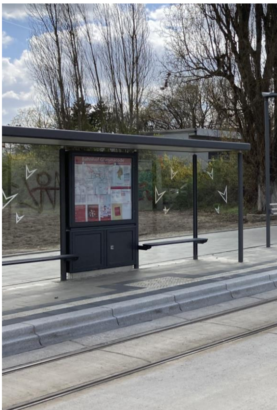
Wetterschutz mit Flachdach und Begrünung (Typ HSI)
