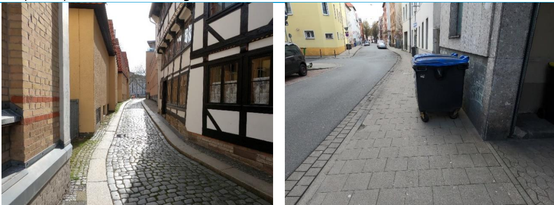
Abbildung 24: Eingeschränkte Barrierefreiheit durch unebene Beläge (links) und Abfallbehälter (rechts) in der Braunschweiger Innenstadt.
