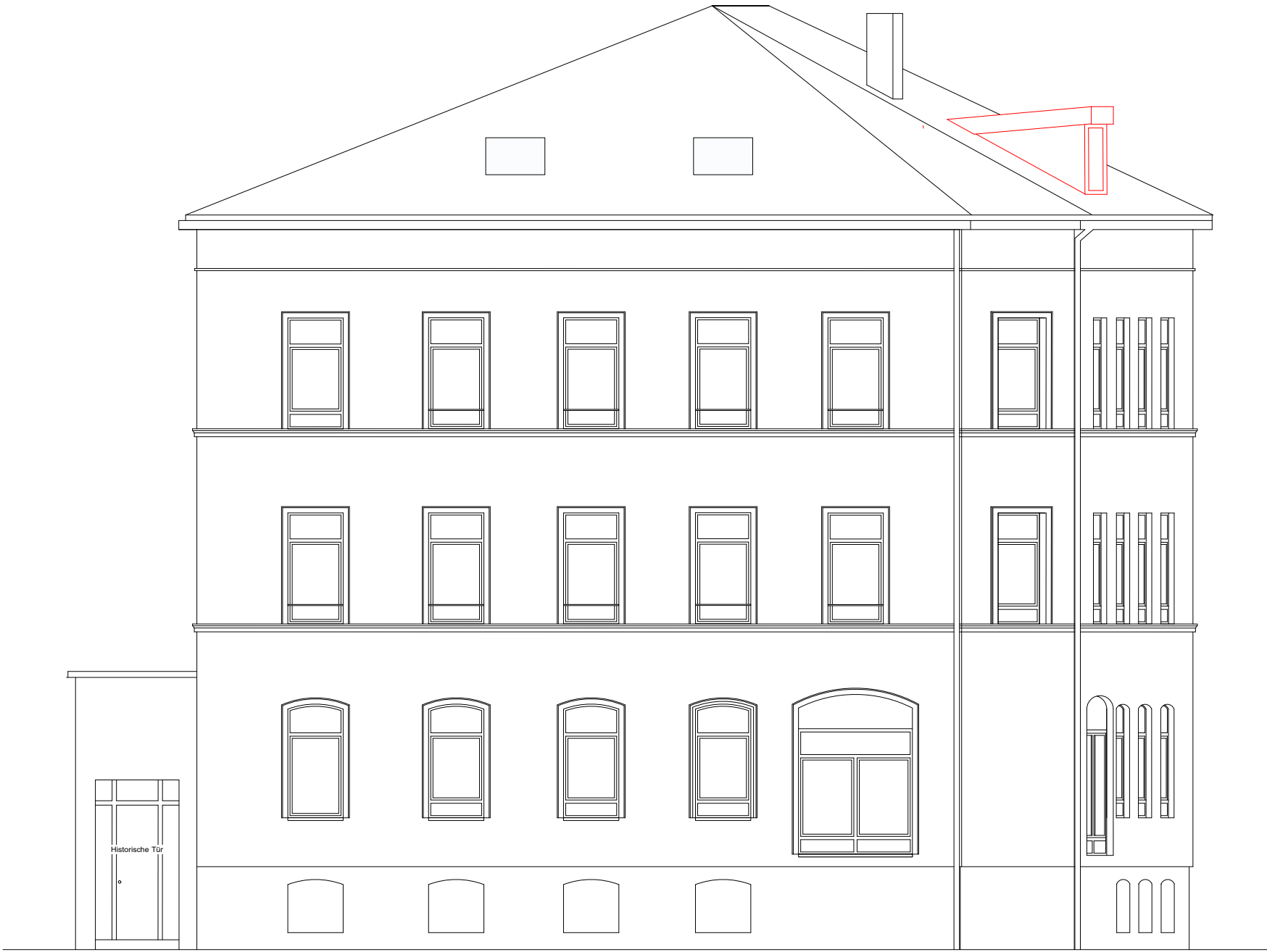
Ansicht Cammannstraße mit WDVS und Fassadenprofilen
