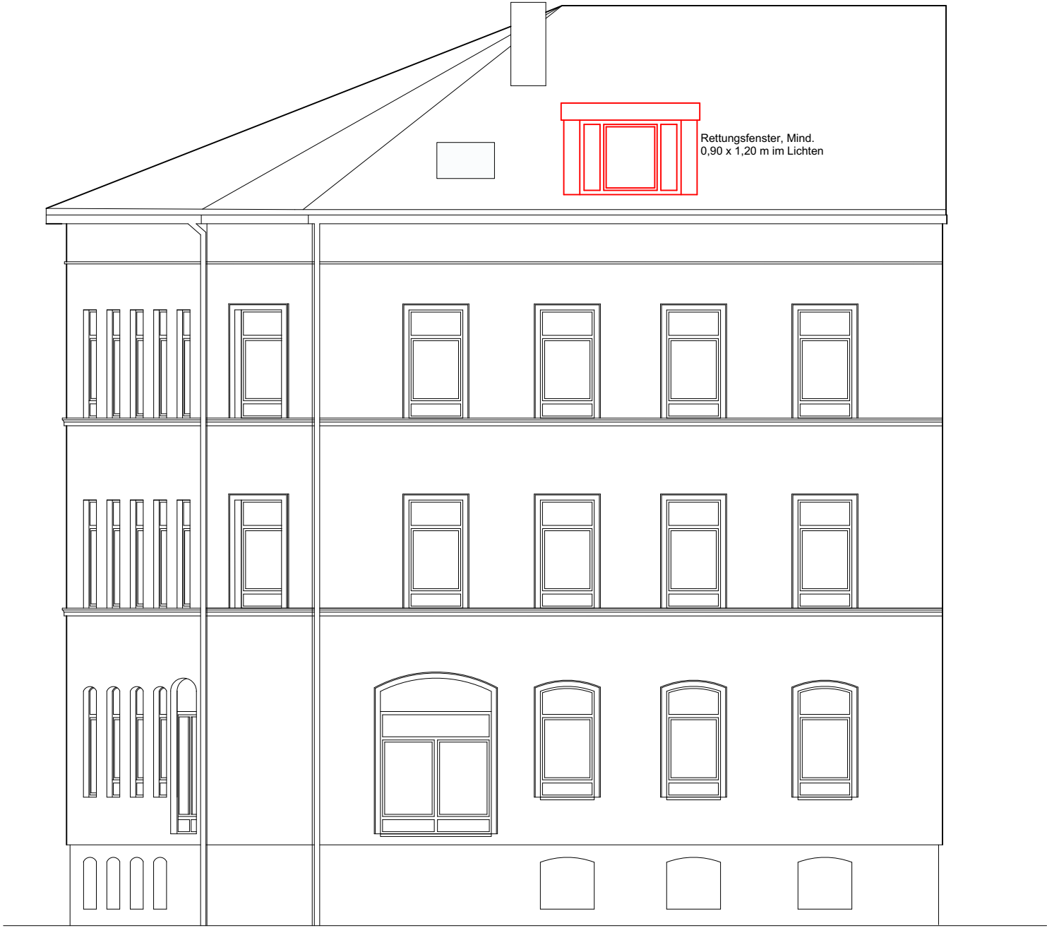
Ansicht Sophienstraße mit WDVS und Fassadenprofilen
