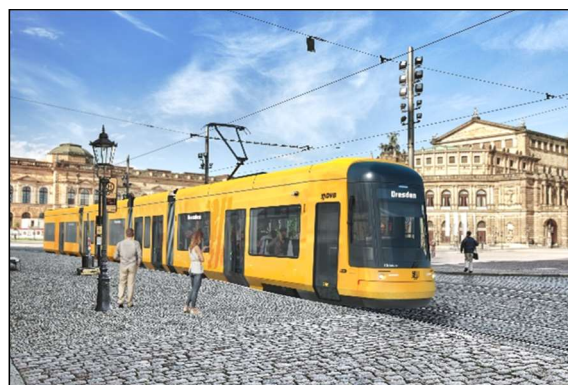
Abbildung 6.6: 2,65 m breites tailliertes Niederflurfahrzeug „NGTDXDD“ für Dresden (Quelle: DVB)
