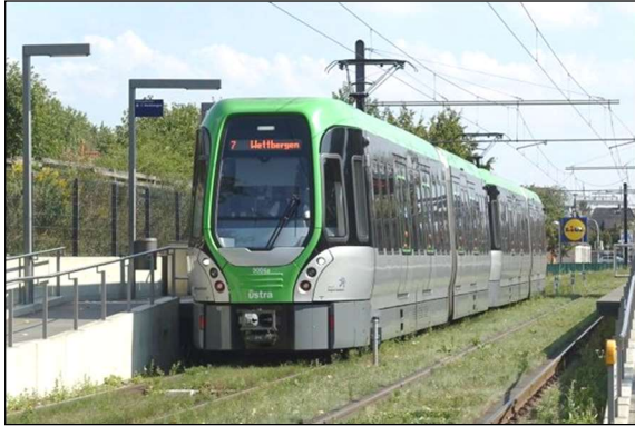
Abbildungen 6.2 und 6.3: 2,65 m breite taillierte Hochflurfahrzeuge „TW 3000“ in Hannover und „Vamos“ in Bielefeld
