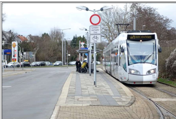
Abbildungen 6.4 und 6.5: 2,65 m breite taillierte Niederflurfahrzeuge „RegioCitadis“ in Kassel und „6N2“ in Rostock
