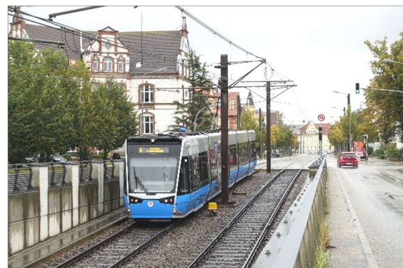
Abbildungen 6.4 und 6.5: 2,65 m breite taillierte Niederflurfahrzeuge „RegioCitadis“ in Kassel und „6N2“ in Rostock
