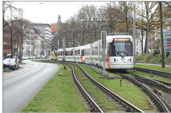
Abbildungen 6.2 und 6.3: 2,65 m breite taillierte Hochflurfahrzeuge „TW 3000“ in Hannover und „Vamos“ in Bielefeld
