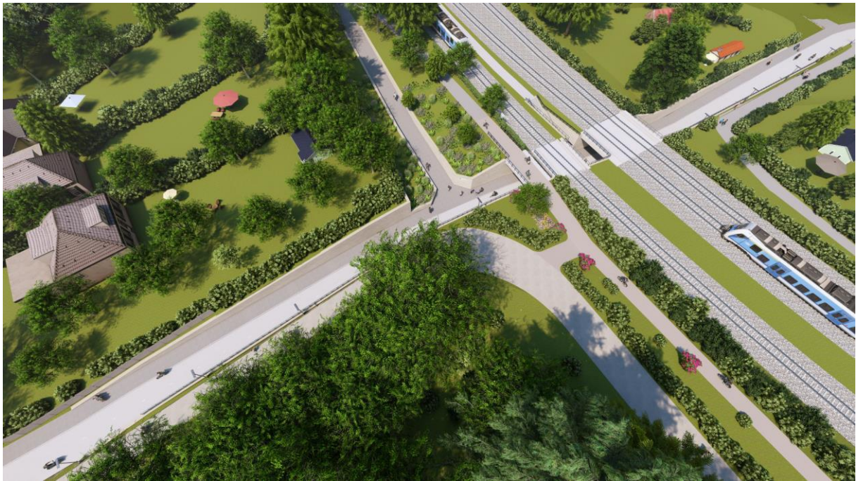
Abb. 7: 3D-Visualisierung der Geh- und Radwegrampe mit Rampe als Verbindung zum Ringgleisweg
