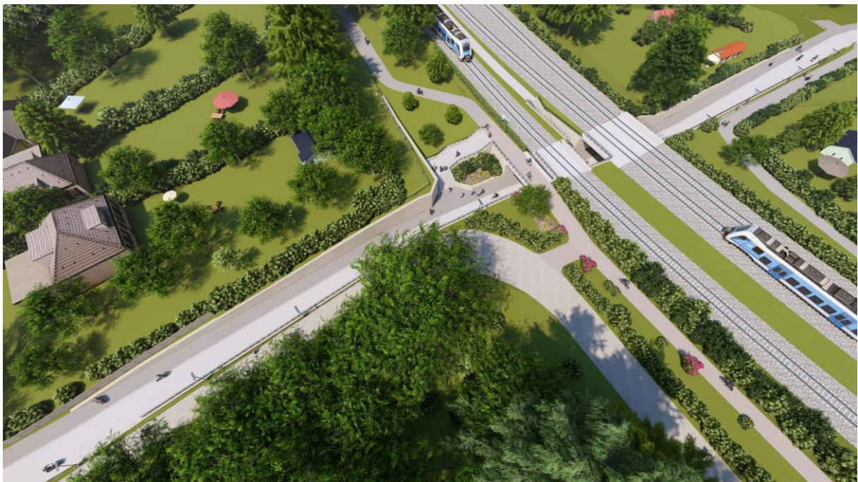
Abb. 8: 3D-Visualisierung der Geh- und Radwegrampe mit Treppe als Verbindung zum Ringgleisweg (Verbesserungsvorschlag zur Variante 1 mit Rampe als Verbindung zum Ringgleisweg)
