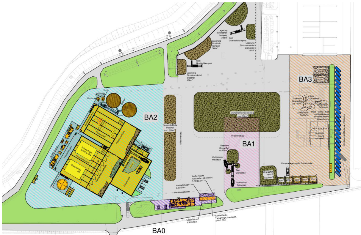
Abbildung 1 Lageplan des geplanten BEZ mit neuer Vergärungsanlage, Grünabfallkompostierung und Darstellung der vorgesehenen Bauabschnitte (Quelle: Präsentation u.e.c.)
