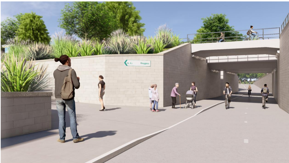
Abb. 2: 3D-Visualisierung im Bereich der westlichen Rampe mit Blick in Richtung Osten auf die Rampe zum Ringgleisweg und die Geh- und Radwegunterführung unter der Brücke vom Ringgleisweg und den Eisenbahnbrücken (Anpassung der Stützwandhöhen gegenüber der Planung von Variante 1 für eine bessere Einsehbarkeit)
