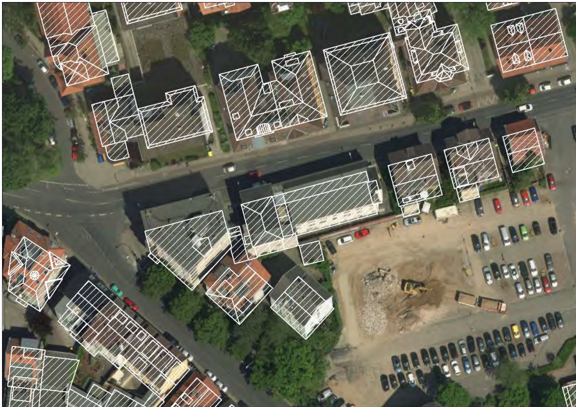
Abbildung 5: Durch Schrägansicht in den Luftbildern lagen die Gebäudeflächen in einigen Fällen nicht exakt über den Geometrien der Gebäude (weiße Linien). Aus diesem Grund wurden die Gebäudeflächen um 2 m vergrößert.
