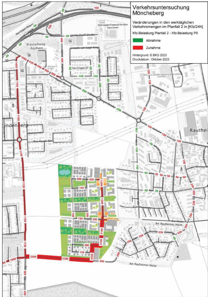
Abbildung 2-9: Veränderungen in den Streckenbelastungen Kfz-Belastung Planfall P2 – Kfz-Belastung P0 2035 (Quelle: Verkehrsmodell Braunschweig, Quelle Hintergrundkarte: © Bundesamt für Kartographie und Geodäsie, TopPlusOpen, 2023)
