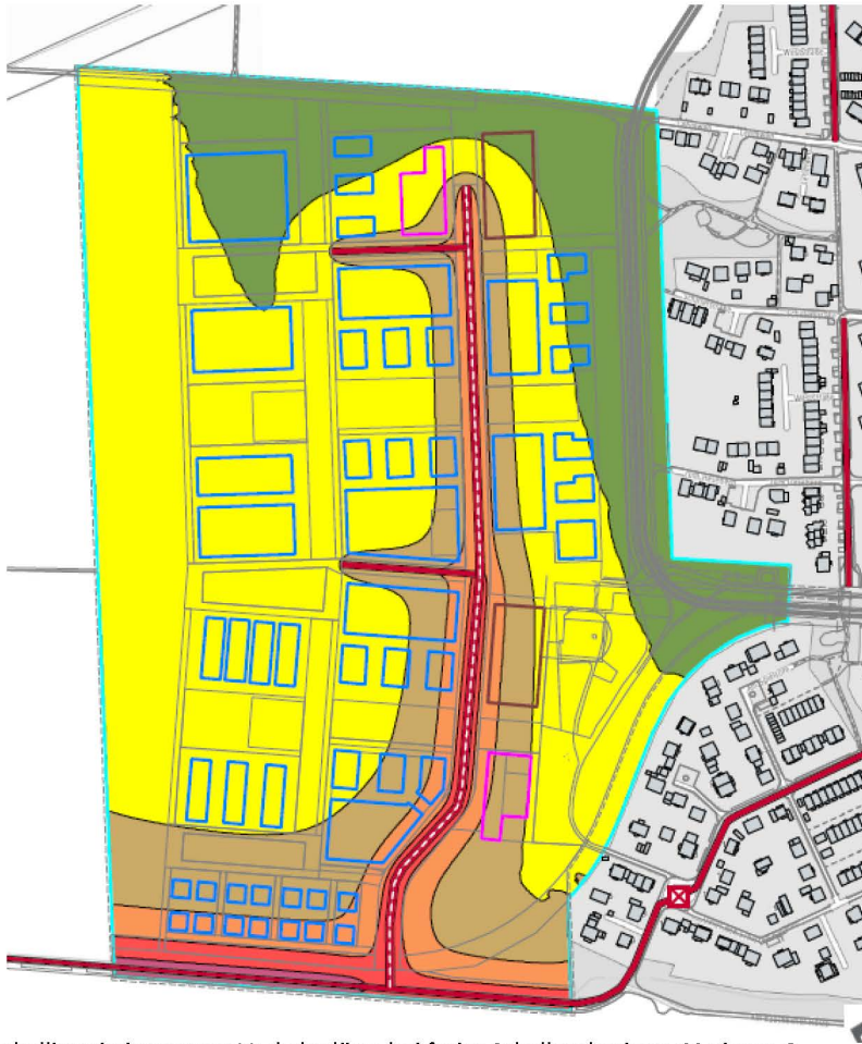
Schallimmissionsraster Verkehrslärm bei freier Schallausbreitung Variante 2 Beurteilungszeitraum Tag (06:00-22:00 Uhr) Rasterhöhe 5,8 m (1. OG) Rasterauflösung 1 m x 1 m
