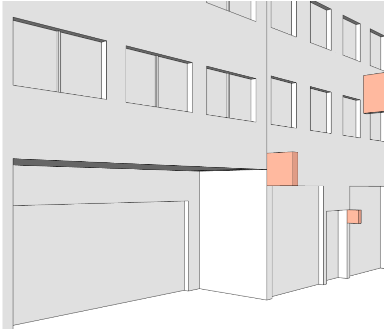
Abbildung 13: Verschiedene Arten von Werbeauslegern an einer Fassade
