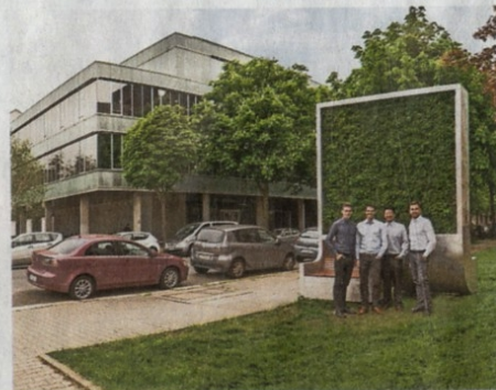
Die mit Moos bepflanzten Wände stehen nicht zur Deko auf großen Plätzen wie hier in Oslo, Berlin oder Dresden. Sie sind da, um die Luft zu reinigen. Immerhin 240 Tonnen an Schadstoffen wie Feinstaub oder Stickoxide nimmt so ein „City Tree“ des Berliner Start-ups „Green City Solutions“ pro Jahr auf. FOTOS: PRIVAT
