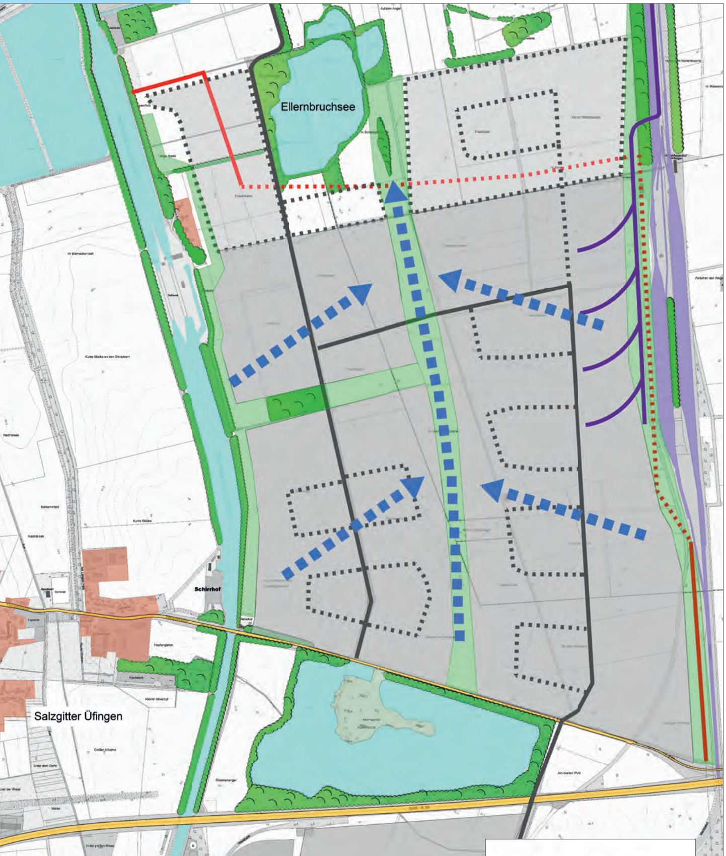
Abbildung: Regenwasser – Entwässerung erfolgt über das Gefälle in Richtung Norden.
