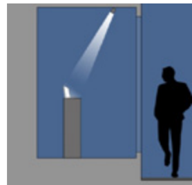
Licht gerichtet auf auszustellende Objekte und Waren
