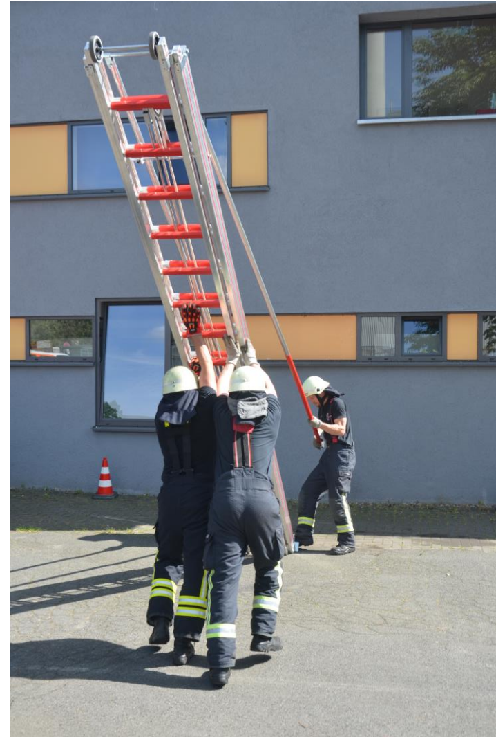
Feuerwehr-Schiebleiter DIN EN 1147, 3-teilig
