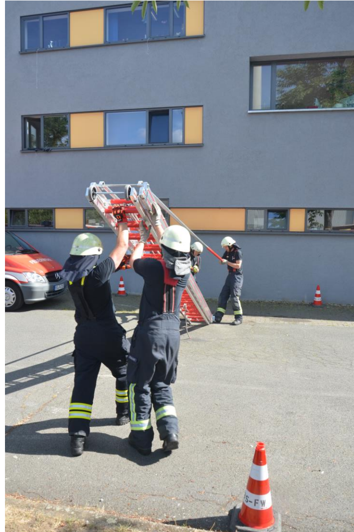
Feuerwehr-Schiebleiter DIN EN 1147, 3-teilig
